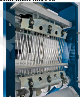
Благодаря системе нарезки Cross-Slice лезвия служат до 3-х раз дольше
