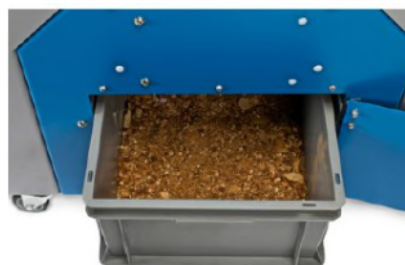
Специально разработанные направляющие способствуют тому, что все крошки, в конечном счете, попадают в съемный лоток.
