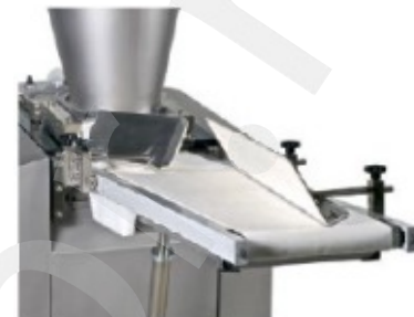
Дополнительное предварительное округление для тестовых заготовок до 700 гр.
